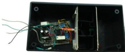
Рис. 4. Блок передачи данных
